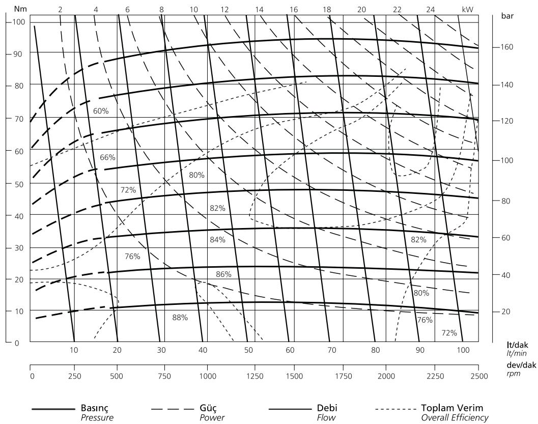
AŞAĞIDAKİ GRAFİK 1600, 1900 ve 2200 DİŞLİ POMPA ve MOTORLARIN İLETİM HACMİ ve ÇALIŞMA BASINCI ARALIKLARINI GÖSTERİR.
